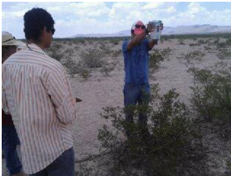
Imagen 27. Obtención de la firma espectral con el uso del espectro-radiómetro
