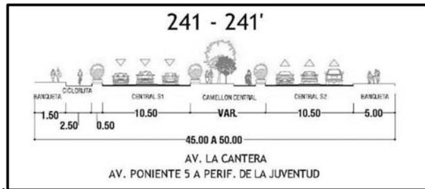
IMAGEN 109.- Sección vial Av. La Cantera Propuesta por el PDU de la ciudad de Chihuahua: Visión 2040.
