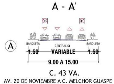
Imagen 57. Vista de la C. 43 va. y su sección vial actual.
