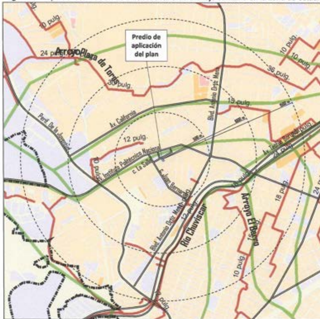
Imagen 49. Mapa de localización de infraestructura de drenaje sanitario en la zona de estudio.
