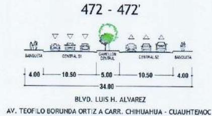
Fig. 70 Sección vial propuesta.<sup>90</sup>
