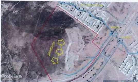
Fig. 58 Sistema de escurrimientos e infraestructura pluvial que inciden al predio.<sup>68</sup>
