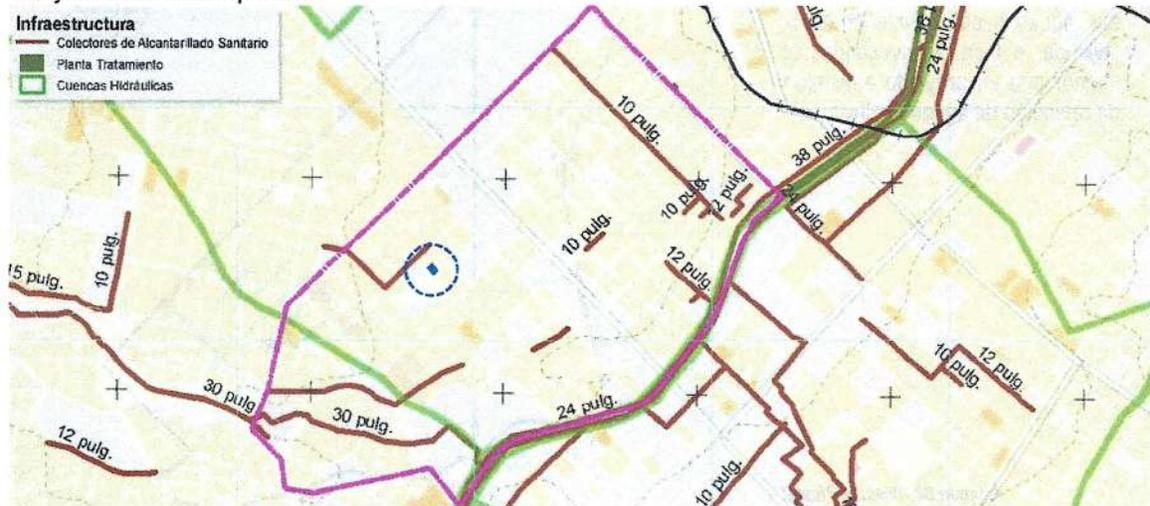
Imagen 81. Infraestructura de Alcantarillado Sanitario. Fuente: PDU 2040.
