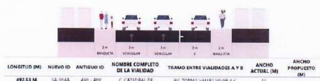
Fig. 56 sección vial existente. 66
