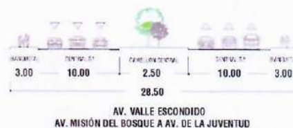
Fig. 58 Sección vial existente. 68
