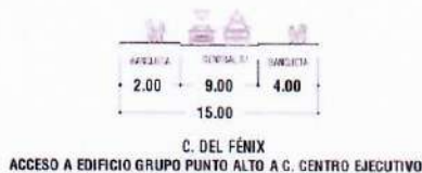
Fig. 60 Sección vial existente. 70
