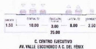
Fig. 59 Sección vial existente. 69
