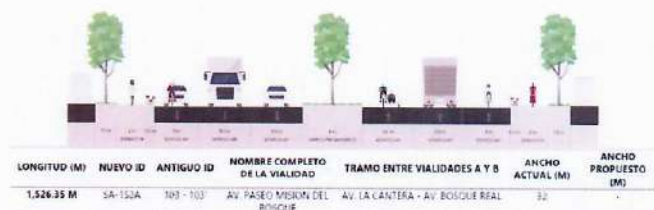
Fig. 53 Sección vial existente. 63
