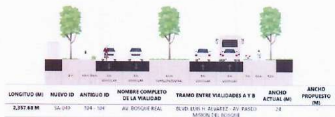
Fig. 54 Sección vial existente. 64
