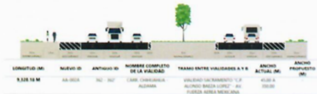
Fig. 53 Sección vial existente. 63
