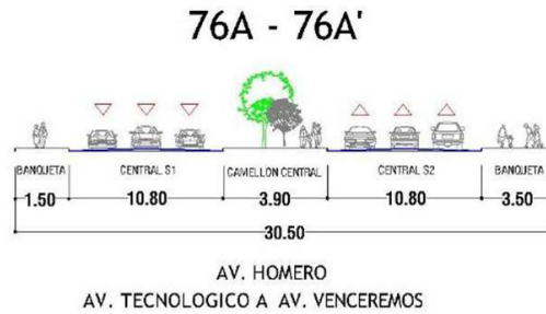
IMAGEN 43.- AV. HOMERO SECCIÓN VIAL. FUENTE: PDU 2040 DEL CENTRO DE POBLACIÓN CHIHUAHUA 6ª ACTUALIZACIÓN.
