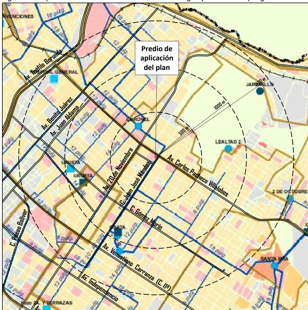
Imagen 48. Mapa de localización de infraestructura de agua potable en el polígono de análisis.
