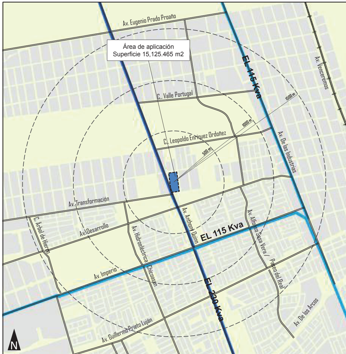
Plano D-13: Medio Construido: Infraestructura de Electrificación.
